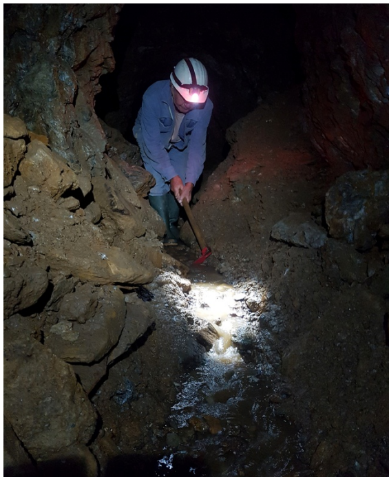
Obrázek 36 Prokopání sesunuté drtě ve štole Bleskovec II
